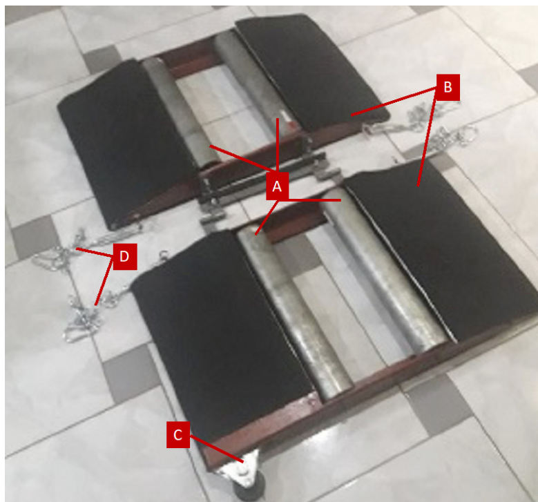
Figura 1 - Vista superior do Dinamômetro Compacto para Cadeirantes (DINACOM)
