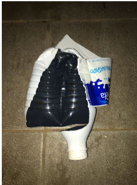
Figura 4: Fotografia ilustrando a parte interna da embalagem com dupla camada de PET. Fonte: Acervo das autoras.
