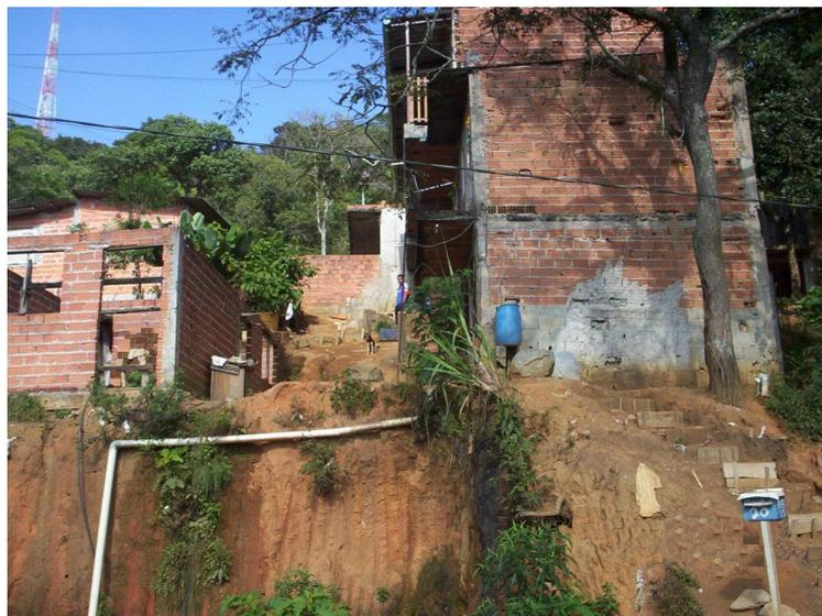
Ilustração 4 Ocupação irregular. Podem ser vistas as ligações clandestinas de água e esgoto.
